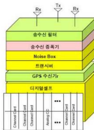
그림16 2G/3G 기지국(BTS) 구조 및 형상
